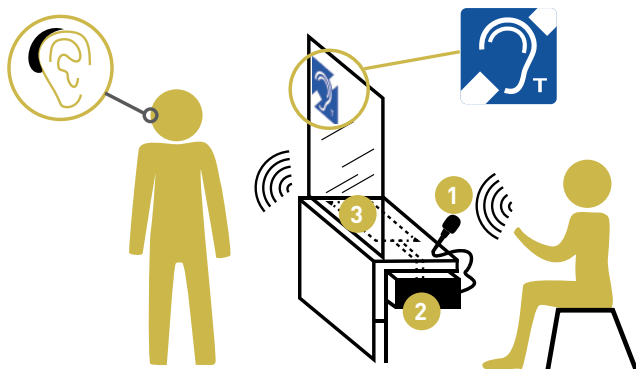
Rys. Schemat działania pętli indukcyjnej okienkowej
